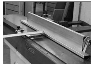
Soporte seguridad para labrar piezas de sección pequeña
